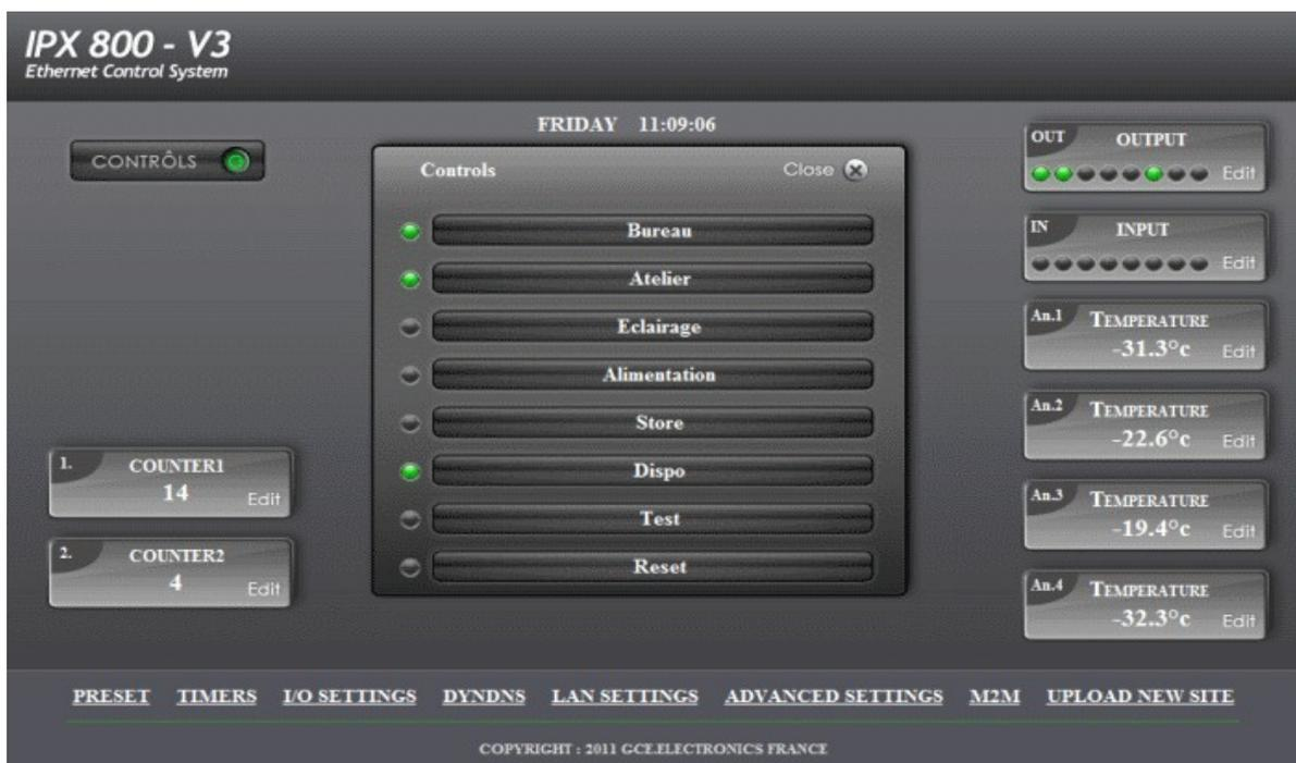
« **OUTPUT** » vous permet de renommer les relais et de déterminer la durée du délai pour le mode Fugitif.
