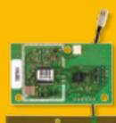
vous permet de saisir jusqu'à 50 points sans fil dans le panneau de contrôle. Oasis utilise la bande de fréquence 868 MHz pour la communication radio
